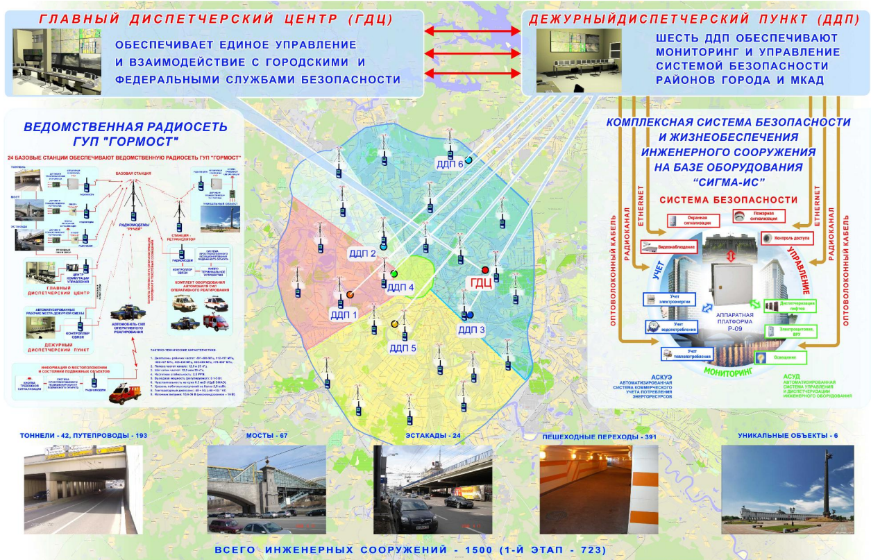
Рис. 7. Структурная схема системы централизованного мониторинга и обеспечения безопасности инженерных сооружений города
