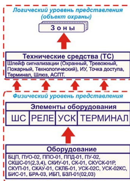
Рис. 1 Внутренняя архитектура конфигурации БЦП
