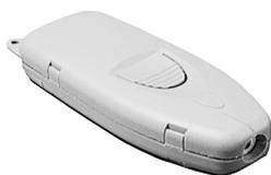
**ЛТ** - лазерный тестер для извещателей серий ПРОФИ, ЕСО1000 и Леонардо. Лазерный тестер ЛТ при передаче дистанционно с расстояния до 6 метров кодированного сигнала на индикатор извещателя обеспечивает его тестирование и включение в режим "Пожар".
