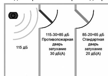
**Рис. 2. Снижение уровня сигнала при наличии дверей.**
