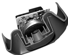
Рис. 6. Акустическая система оповещателя серии ЕМА
