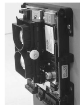
Рис. 2. Оптический зеркальный "прицел" для грубой юстировки
