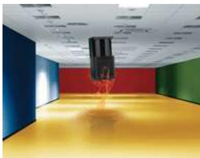
Перейдем теперь к звуковым извещателям разбития стекла. Контролируемый физический параметр – звук разбиваемого стекла – является колебаниями в диапазоне 100-10 000 Гц, с огибающей с примерно теми же характерными временами 0.2-2 секунды. В отличие от инфракрасного извещателя, в
