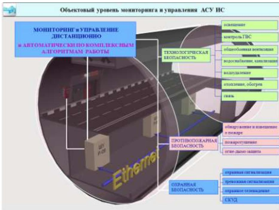
Рис.3 Основные возможности системы объектового мониторинга
