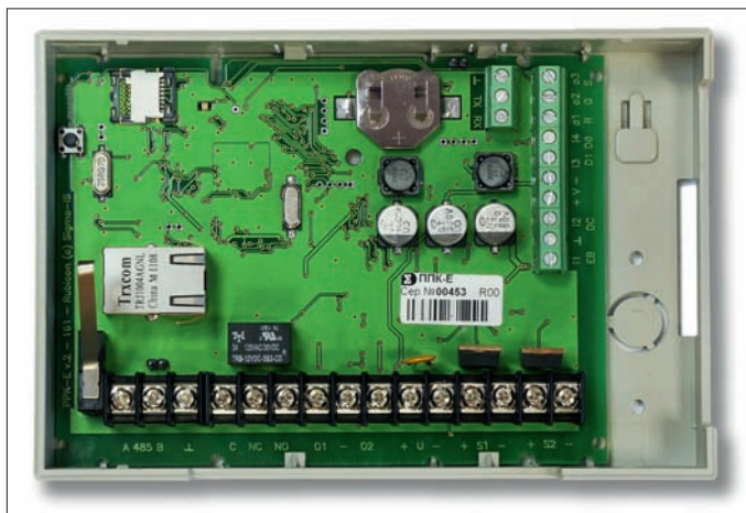
Внешний вид ведущего контроллера доступа
