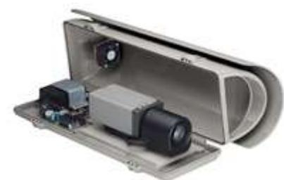
значимый запас прочности для обеспечения бесперебойной работы камеры видеонаблюдения в условиях суровой российской зимы. Встроенный обогреватель, регулируемый термодатчиком, обеспечивает равномерную температуру по всему объему кожуха. Для гарантированного предотвращения запотевания стекла предусмотрена возможность дополнительной установки вентилятора. Возможность установки IP-камер также предоставляет серия NOV.
