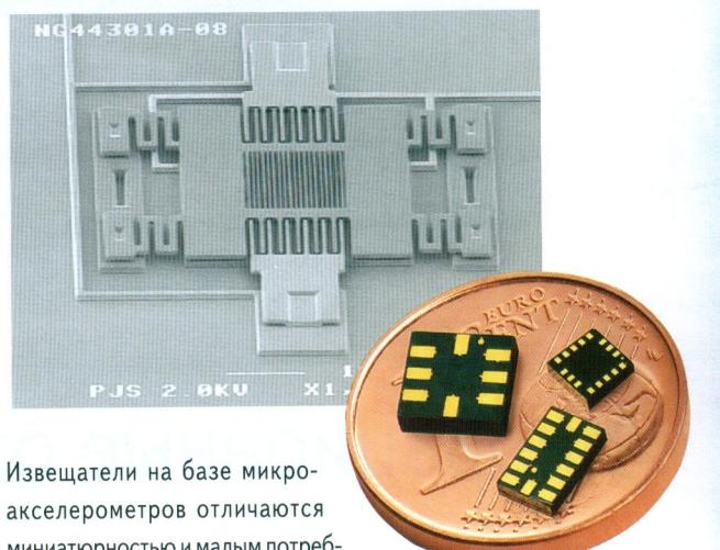
Извещатели на базе микроакселерометров отличаются миниатюрностью и малым потреблением, высокой технологичностью
