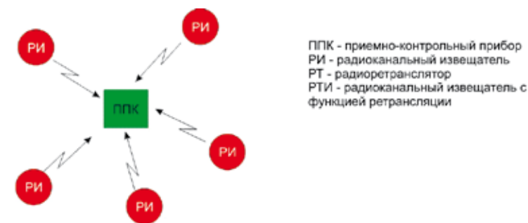
Топология радиосистемы типа "Звезда"
