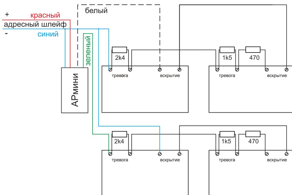
В заключение напомним, что, поскольку сухой контакт не имеет полярности, провода можно менять местами, изображенные на рисунках варианты всего лишь одни из возможных вариантов, их можно менять как удобнее производить монтаж, руководствуясь здравым смыслом и законами Кирхгофа.
