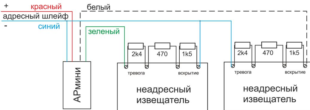
Первый извещатель будет виден как АРмини.1.1, его датчик вскрытия – АРмини.1.2, а второй – АРмини.2.1 и его датчик вскрытия, соответственно, АРмини.2.2.
