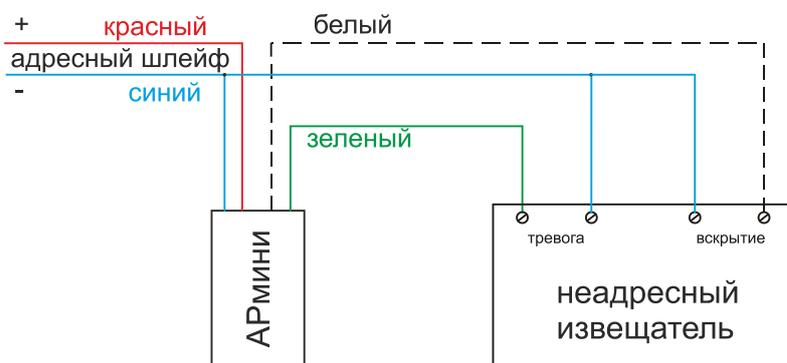
В таком случае используются оба шлейфа в режиме 1 НЗ без контроля. В системе сигнал собственно извещателя будет представлен как АРмини.2.1, а сигнал вскрытия как АРмини.1.1.
