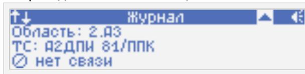
Подробное описание события появления неисправности в области А3. Здесь видно, что неисправность вызвана пропаданием связи с извещателем.
