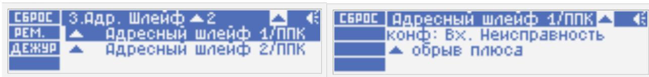
Адресный шлейф 1 находится в состоянии обрыва по плюсовому проводу. Если обрыв имеет место по двум проводам, состояние шлейфа будет «обрыв».
