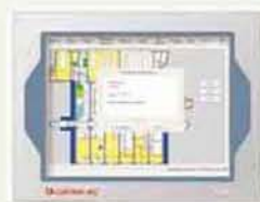
исполнение 6: встроенный сенсорный терминал оптимизирован для организации АРМ оператора
