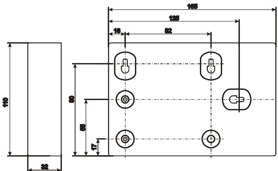
Рис. 2 Габаритные и присоединительные размеры СКАУ исп.2 IP20
