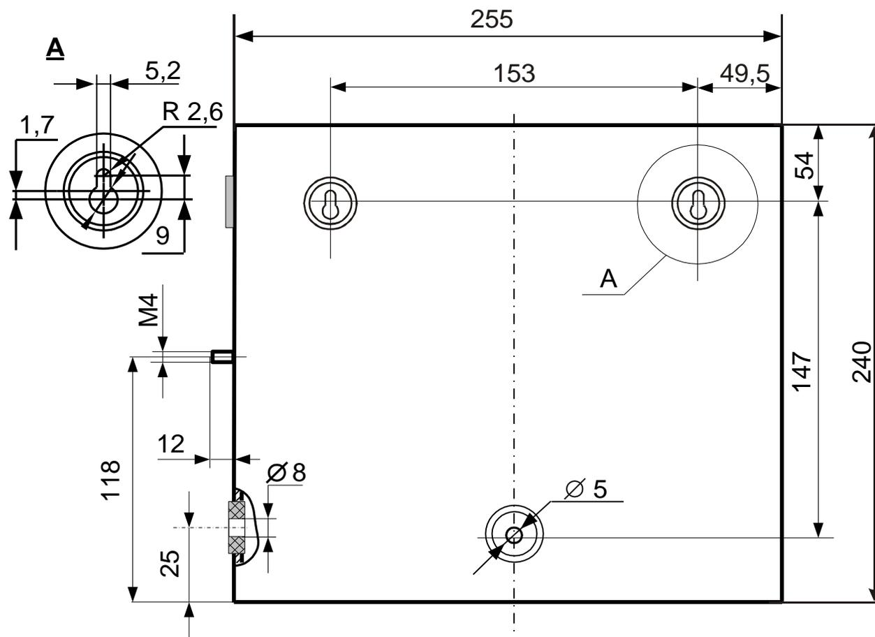
Рис. 5 Габаритные и присоединительные размеры СКАУ исп. 1
