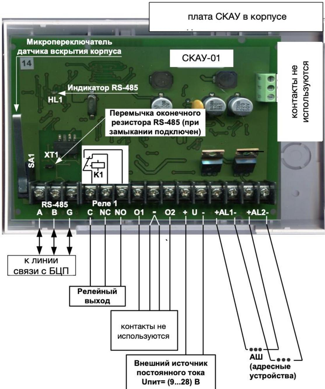
**Рис. 1 Внешний вид SKAU исп.2 IP20. Клеммы подключения.**
