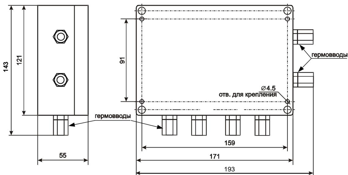
Рис. 3 Габаритные и присоединительные размеры СКАУ исп.2 IP65
