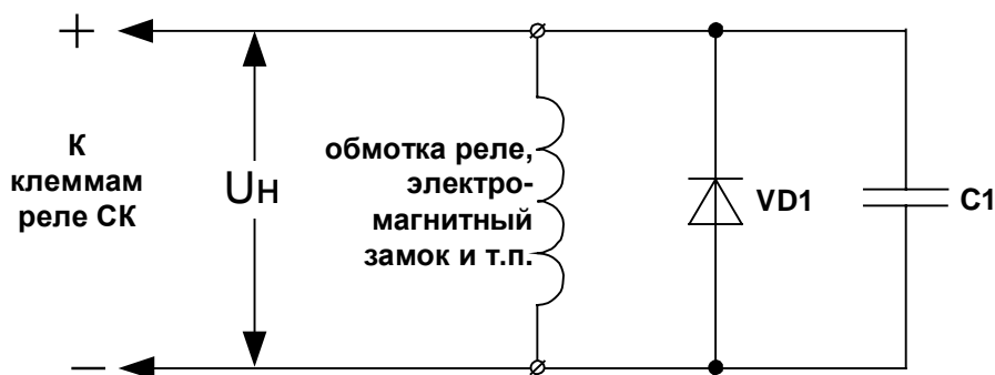
Рис. 6 Схема электрическая принципиальная шунтирующей цепи при подключении индуктивной нагрузки к клеммам реле СК
