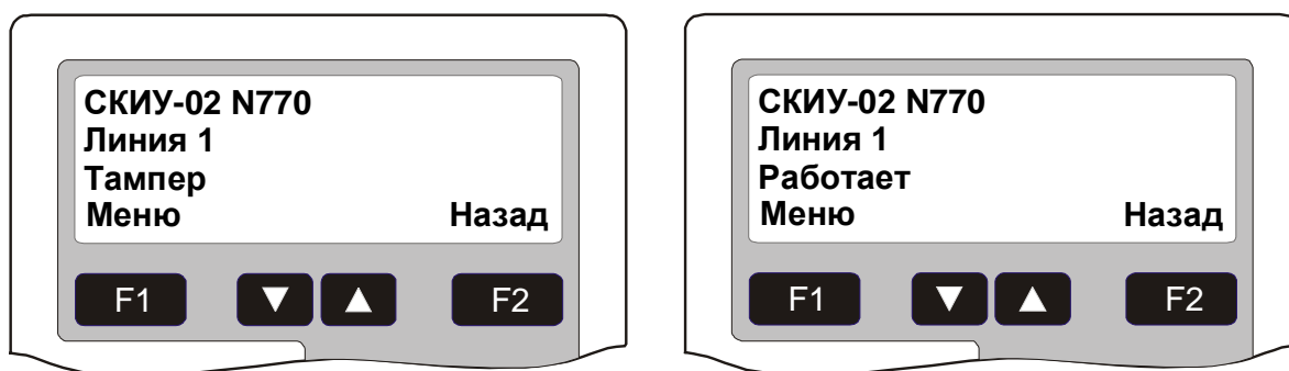
Рис. 6 Окно состояния СКИУ при открытой крышке корпуса (слева) и закрытой крышке (справа)
