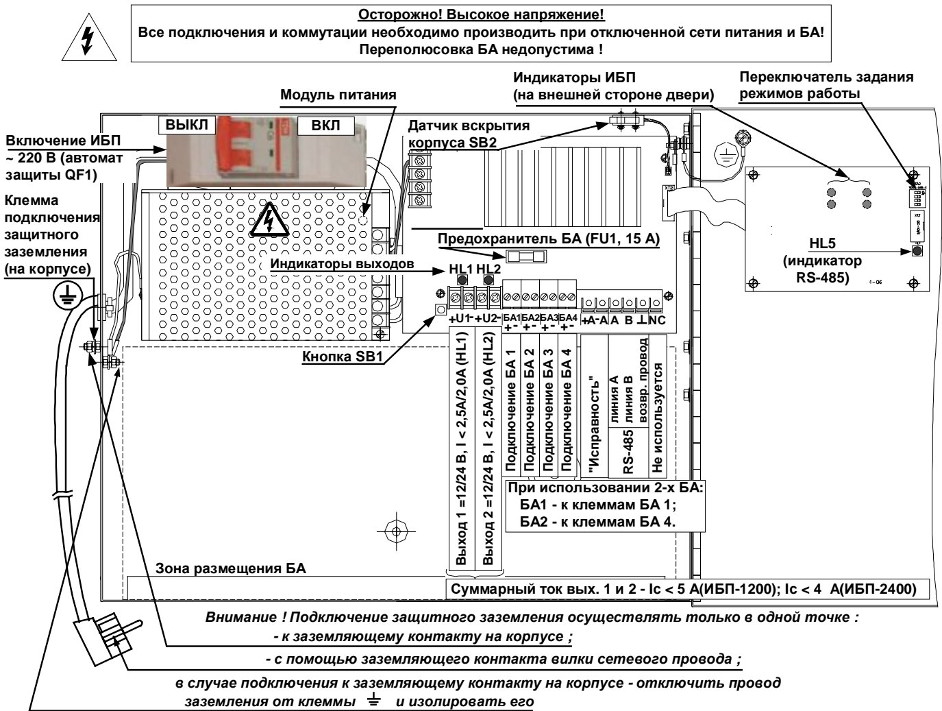
Рис. 2 Внешний вид ИБП-1200/2400 исп. 1 с открытой дверью
