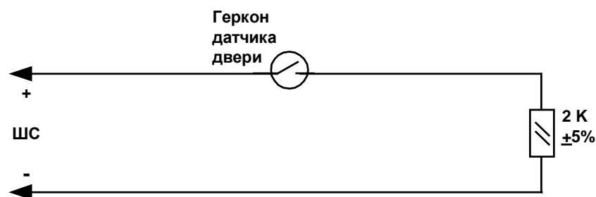
Рис. 18 ШС для контроля состояния датчика двери
