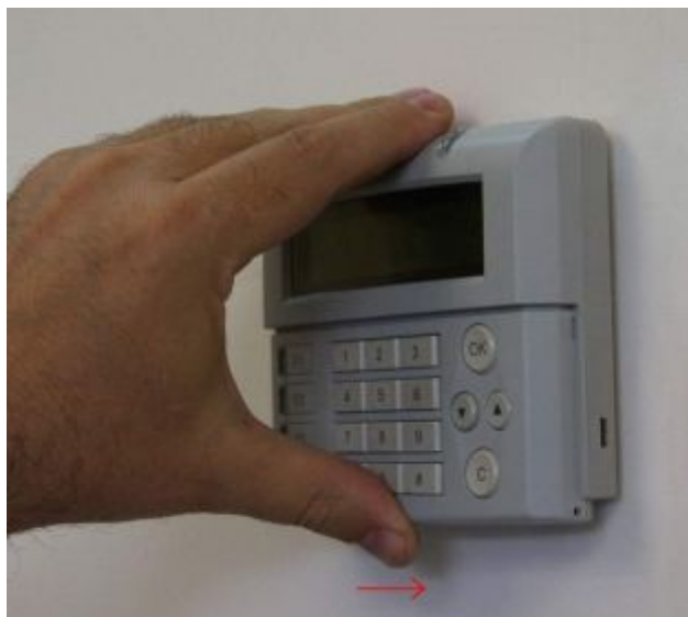
Рис. 4 Снятие и установка крышки ПУО
