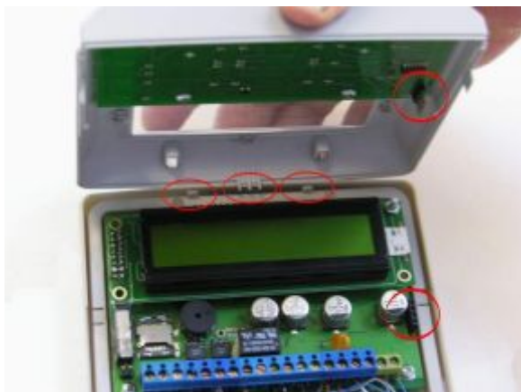
Рис. 4 Снятие и установка крышки ПУО
