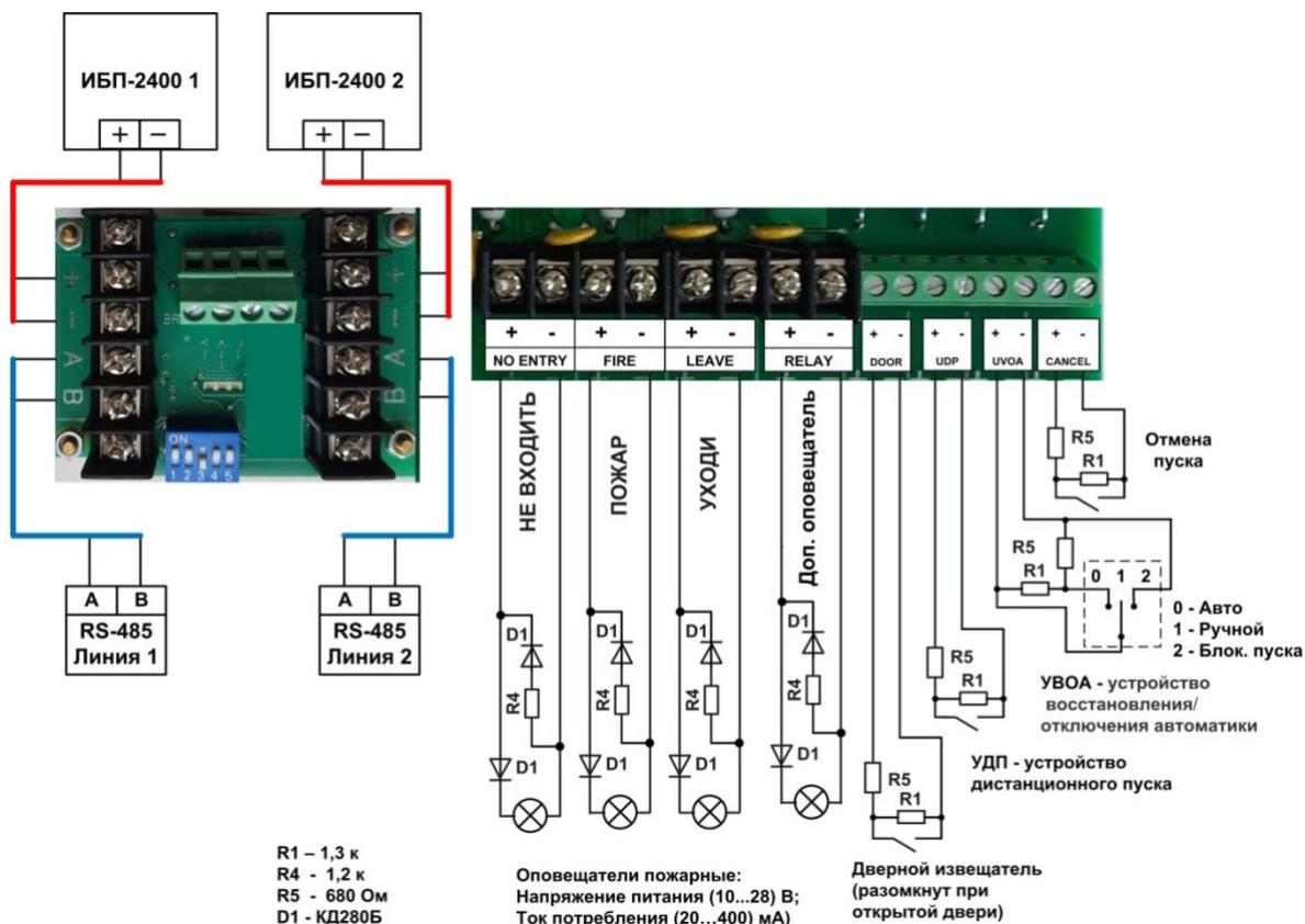
Рис.5. Схема подключения внешних цепей
