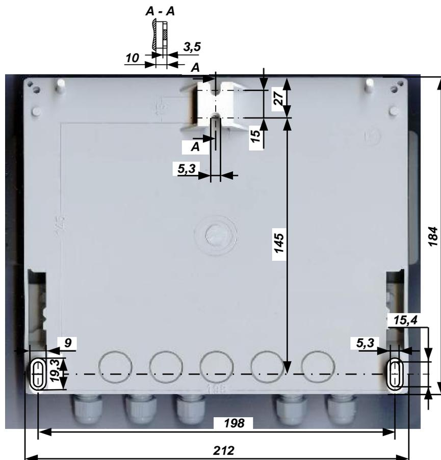
Рис.4. Габаритные и присоединительные размеры
