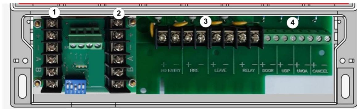
**Рис.2. Клеммы подключения внешних цепей**
