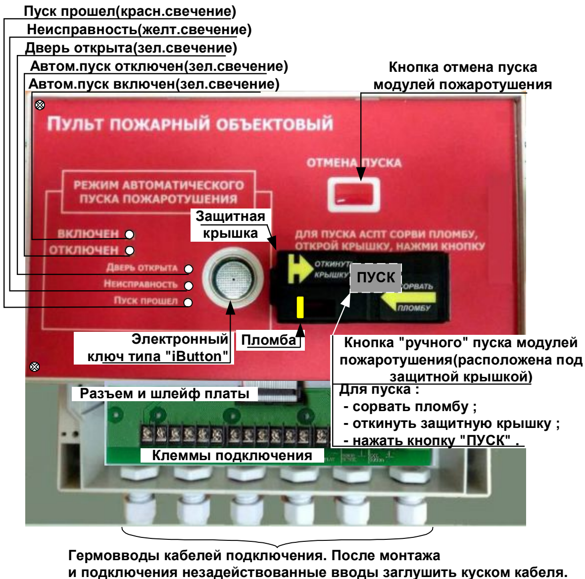
Рис. 2 Внешний вид ППО с открытой крышкой (количество гермовводов может быть изменено)
