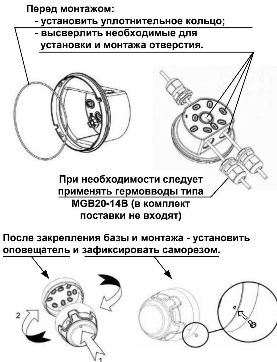
Рис. 4 Сборка и монтаж
