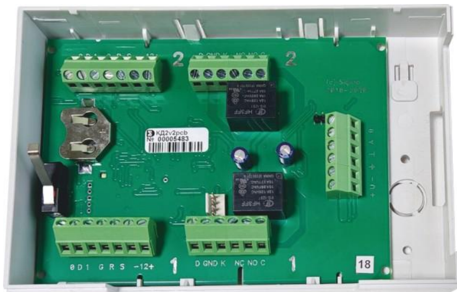
Рис. 2 Расположение элементов КД2 исп.08 на плате (базовый вариант исполнения, IP20).
