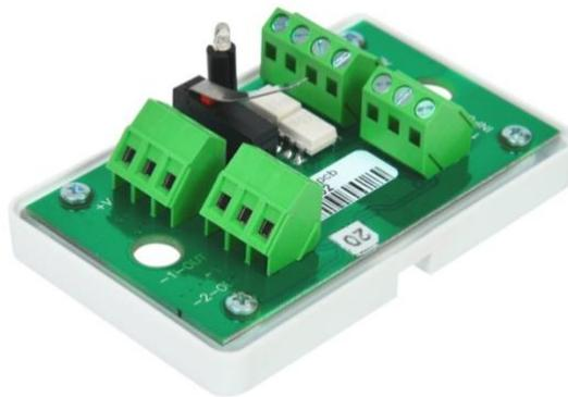
*Рис. 1 Внешний вид ИСМ5 со снятой крышкой.*
