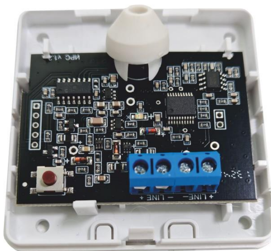
Рис. 2 ИРС исп.08. Основание корпуса с платой
