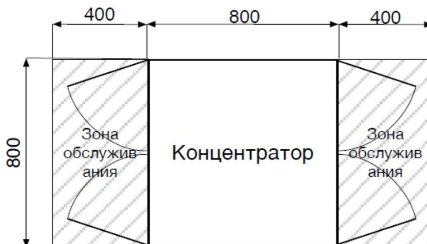
**Рис. 4 Зоны обслуживания концентратора с двухстворчатыми дверями**
