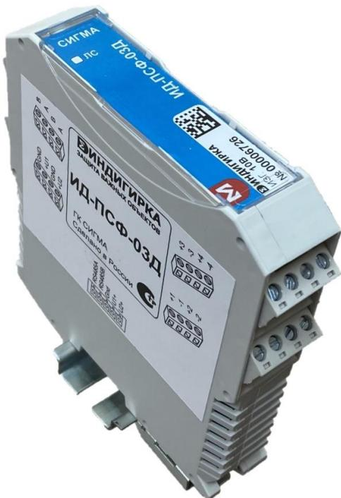
Контроллер шлейфов сигнализации ИД-ПСФ-03Д предназначен для приема электрических сигналов тревожных сообщений от охранных и пожарных извещателей, технологических датчиков с нормально-замкнутыми и нормально-разомкнутыми контактами, а также для передачи информации о состоянии извещателей, шлейфов сигнализации (включая его адрес) в управляющий контроллер (БЦП).
