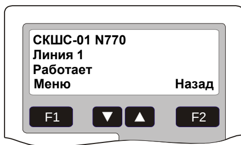
Рис. 14 Состояние работоспособности ПСФ
