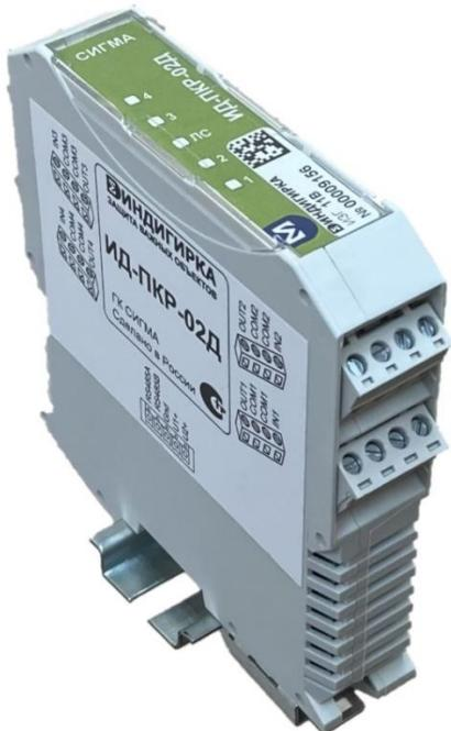
Сетевой контроллер исполнительных устройств ИД-ПКР-02Д предназначен для приема управляющих сигналов с БЦП прибора и управления 4-мя релейными выходами с контролем состояния цепей управления, передачи информации о состоянии релейных выходов (включая его номер), а также состоянии питающего напряжения изделия в БЦП прибора.
