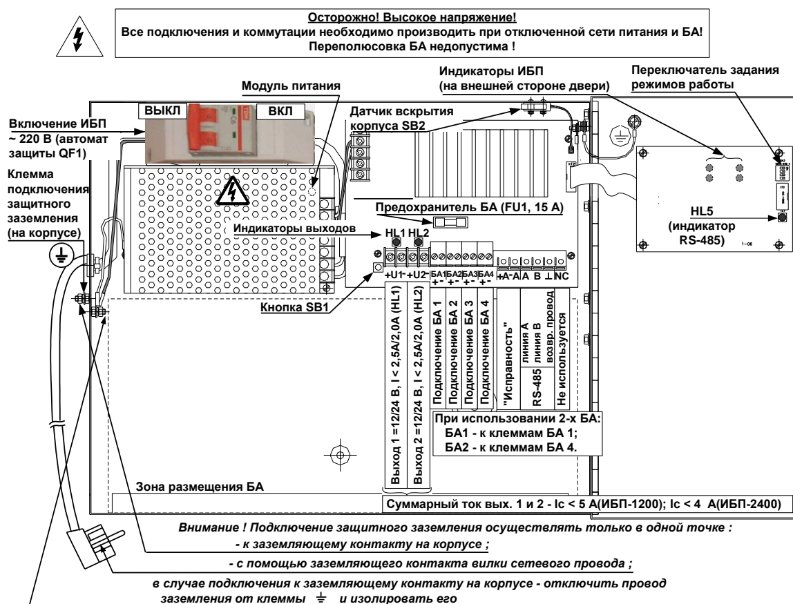
Рис. 3 Внешний вид ИБП-1200/2400 исп. 1 с открытой дверью
