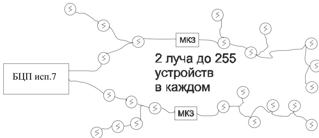
**Рис. 5 Подключение адресного шлейфа в режиме «два луча».**
