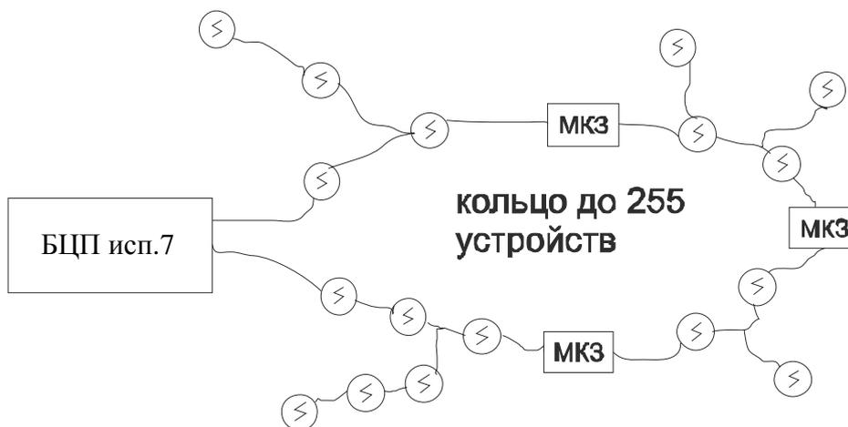
**Рис. 4 Подключение адресного шлейфа в режиме «кольцо».**
