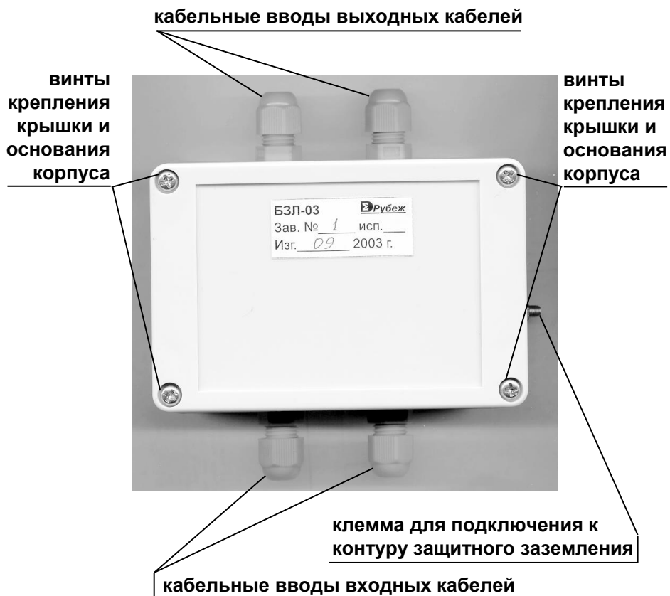
Рис. 10. БЗЛ-02, БЗЛ-03. Кабельные вводы
