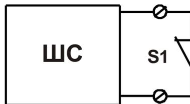
**Рис. 3** Подключение извещателя с НЗ контактами без контроля целостности линии связи
