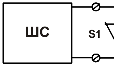
Рис. 8 Подключение НЗ контактов без контроля целостности линии связи.
