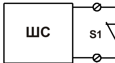
Рис. Схема 3 Подключение НЗ контактов без контроля целостности линии связи.
