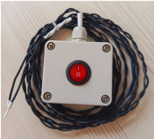
Рис. 1. Имитатор КЗ АШ. Внешний вид.
