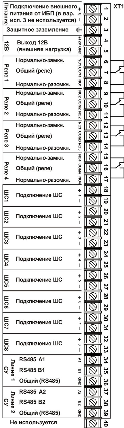
Рис. 17 Схема подключения БЦП (исп. 2)
