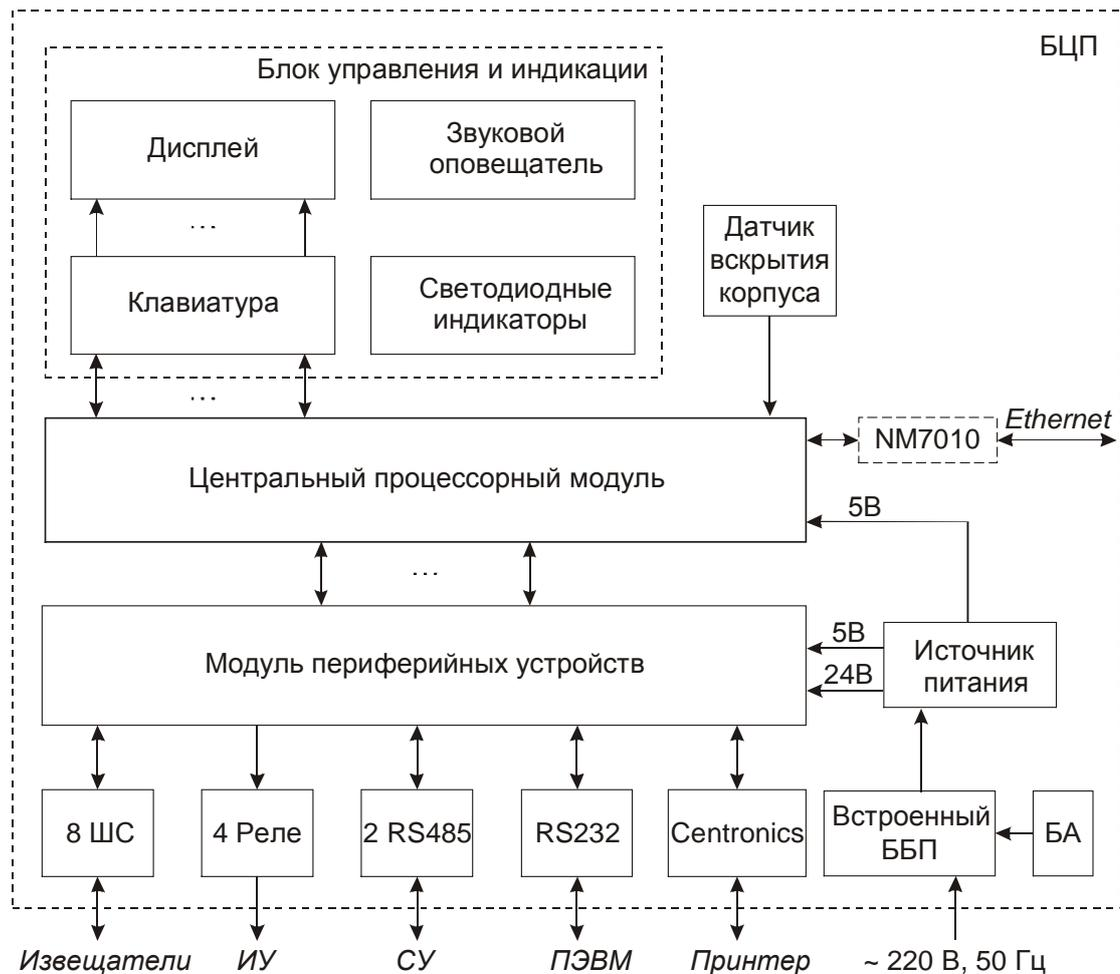
Рис. 3 Электрическая структурная схема БЦП Р-08 исп. 3
