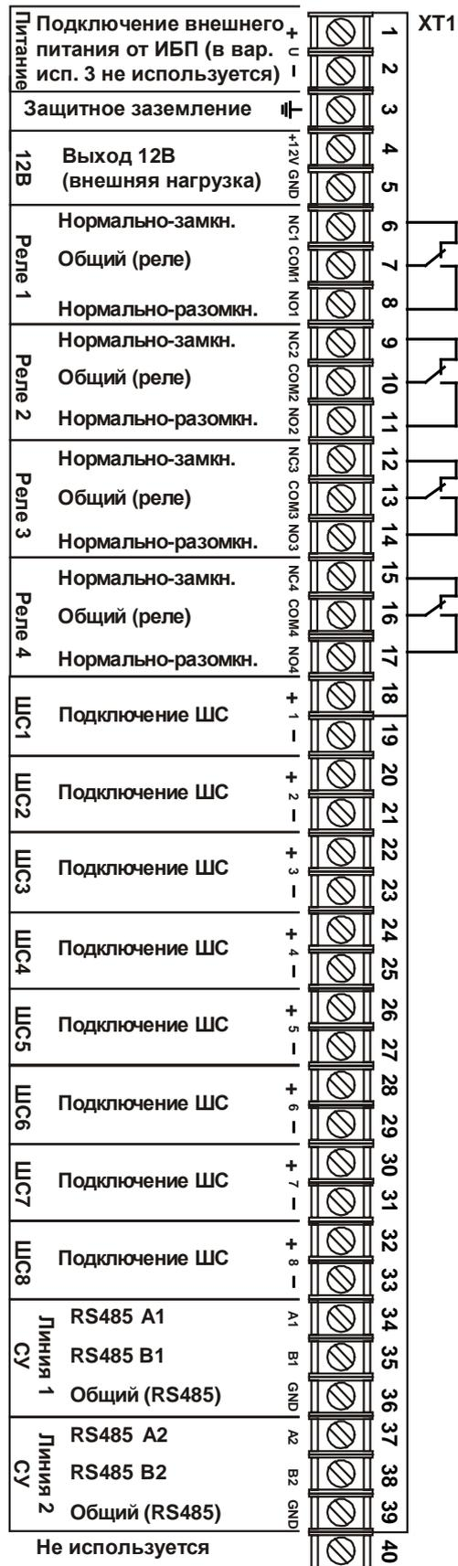
Рис. 32 Назначение разъемов ХТ1 БЦП исп. 2,3
