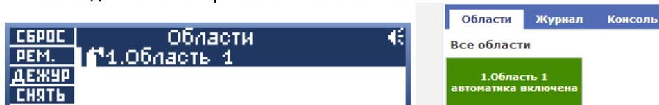
В режим «Автоматика включена» область может перейти, только если в ней присутствуют технические средства «Пуск АУПТ».
