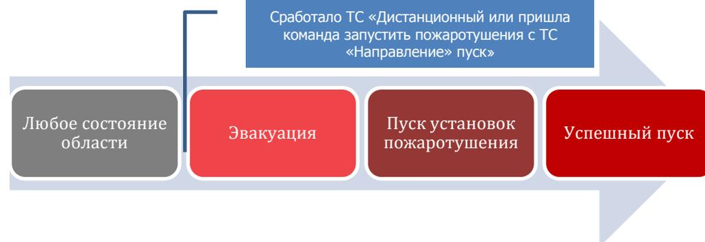
По умолчанию ТС «Дистанционный пуск» не может запустить пожаротушение если есть сработавшее ТС «Отмена пуска/Дверь», но это можно обойти через специальную настройку «Принудительно» у ТС «Дистанционный пуск».
