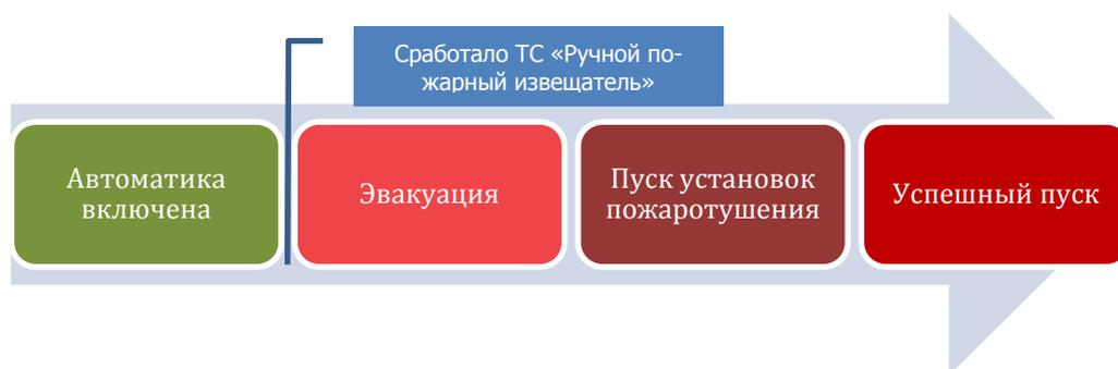
Но при отключенной автоматике срабатывание этого ТС, приведет только к состоянию «Пожар 2 в области»:
