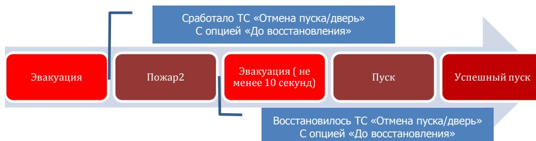
Если у ТС «Отмена пуска/дверь» отмечена опция «Сбросить счетчик», то отсчет времени эвакуации после его восстановления начинается сначала.
