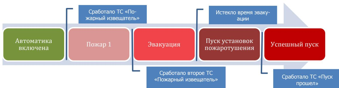
Количество сработавших ТС «Пожарный извещатель» для запуска эвакуации может быть определено в настройках области опцией «Число извещателей для перехода в пожар 2». По умолчанию это значение равно двум, но может быть изменено.
