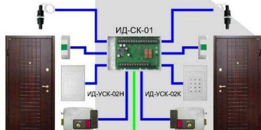
Оборудование обеспечивает контроль и управление двумя точками доступа. Для контроля положения двери используются магнитоконтактные датчики. Предусматриваются кнопки выхода для открывания электрозамка помещения. Проход возможен при помощи проксимити-карт или при набора кода
