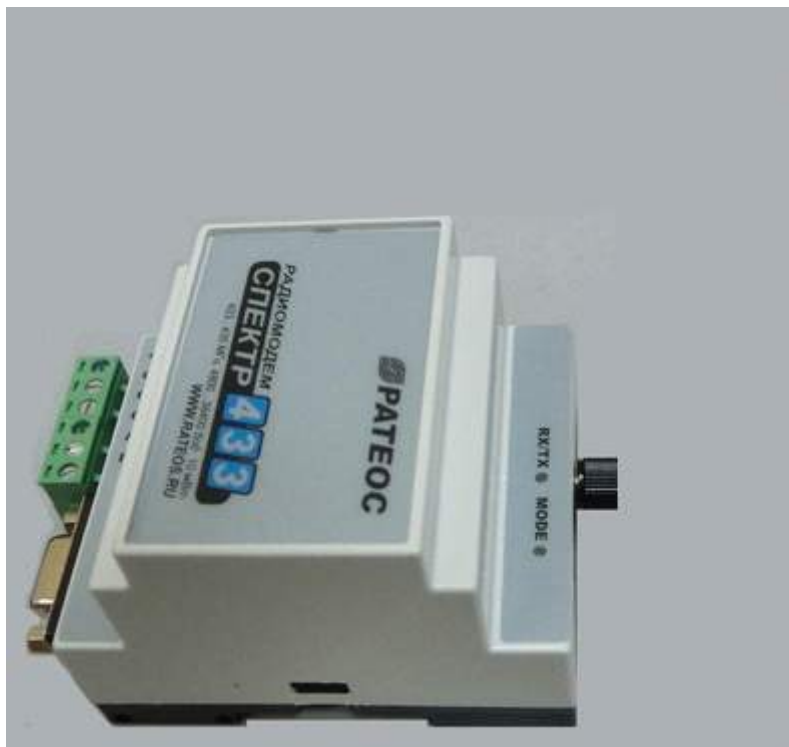
Рис. 2 Внешний вид радиомодема СПЕКТР 433 (вариант DIN рейки, без антенны)
