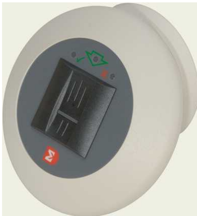
Рисунок 79 Внешний вид биометрического считывателя ШУ024-2 (конструкция с тепловым сканером и накладного крепления)
