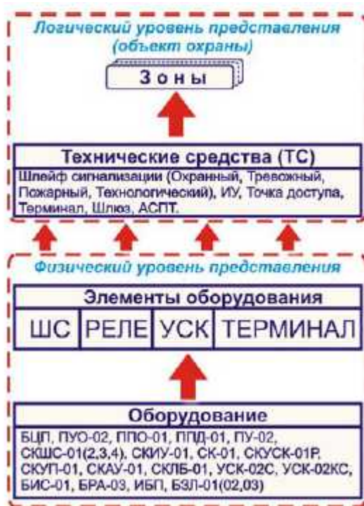
Рисунок 72 Внутренняя архитектура конфигурации БЦП
