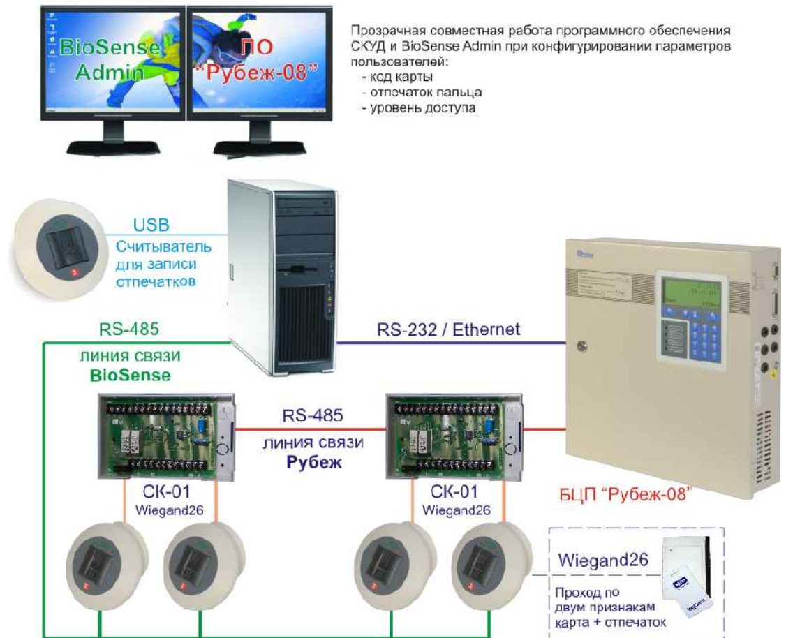
Рисунок 81 Варианты применения биометрического считывателя
