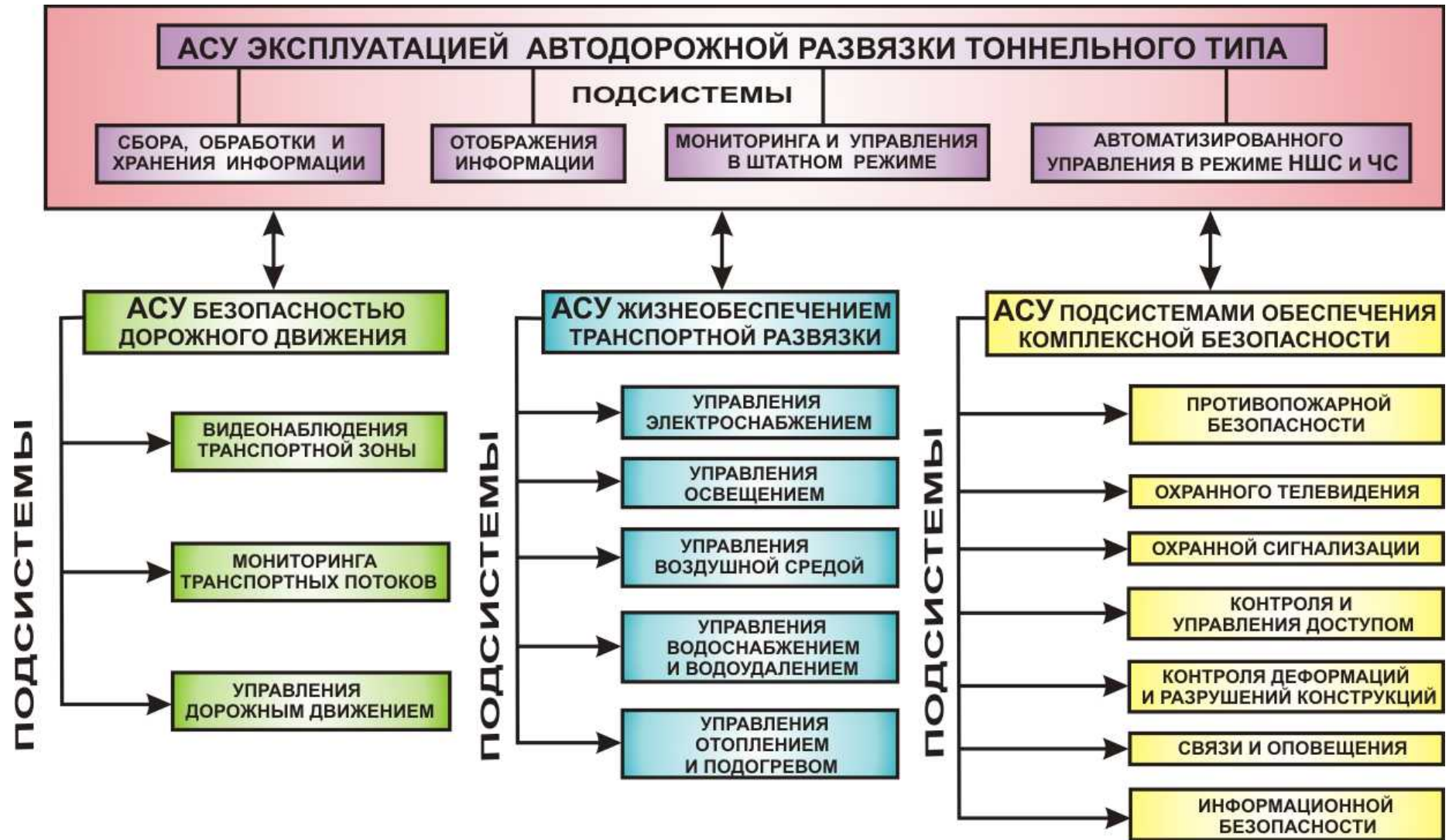
Рисунок 103 Состав основных функциональных подсистем АСУ путепровода тоннельного типа
