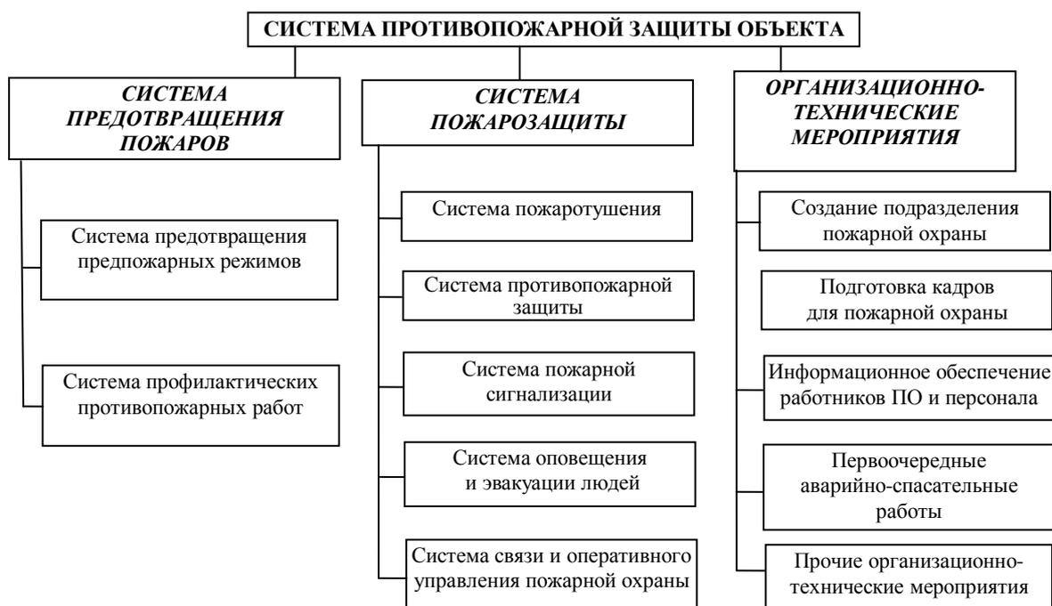
Рис. 1. Обобщённая структура системы противопожарной защиты объекта
