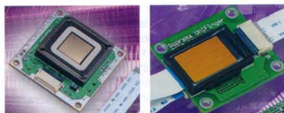
Рис. 5. Дактилоскопический емкостный сканер и считыватель на его основе
