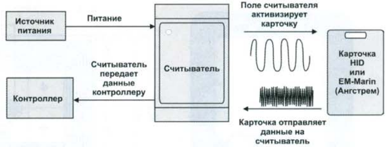
Рис. 8. Принцип радиочастотной идентификации
