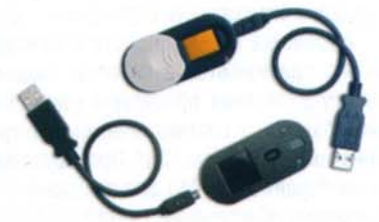
Рис. 5. Дактилоскопический емкостный сканер и считыватель на его основе
