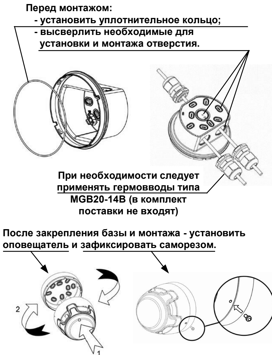
Рис. 4 Сборка и монтаж
