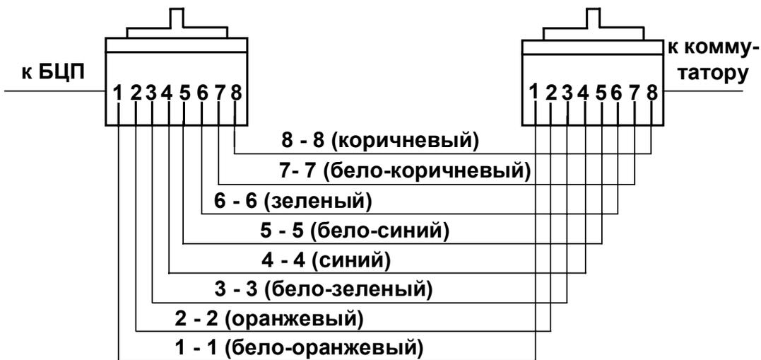
**б) Прямой кабель (соединение БЦП и коммутатора)**
