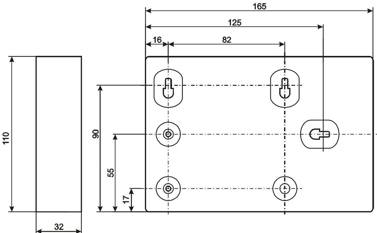
**Рис. 3** Габаритные и присоединительные размеры БЦП исп. 7У.
