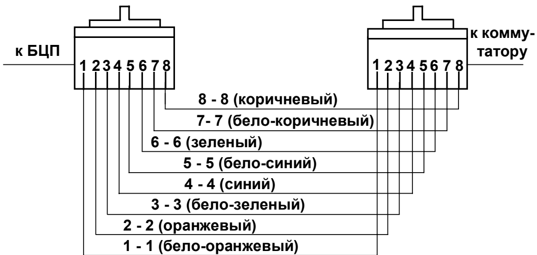
б) Прямой кабель (соединение БЦП и коммутатора)
