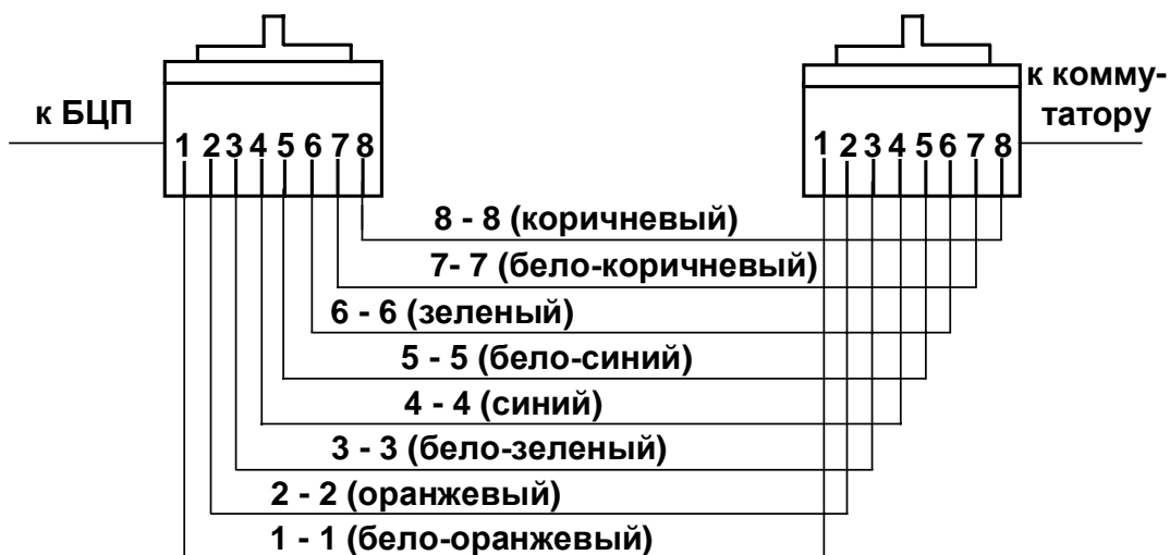
б) Прямой кабель (соединение БЦП и коммутатора)
