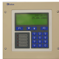
БЦП (исполнение 6) – в корпусе пульта ПУ-02 в едином конструктиве со встроенным пультом управления и электропитанием от внешнего источника
