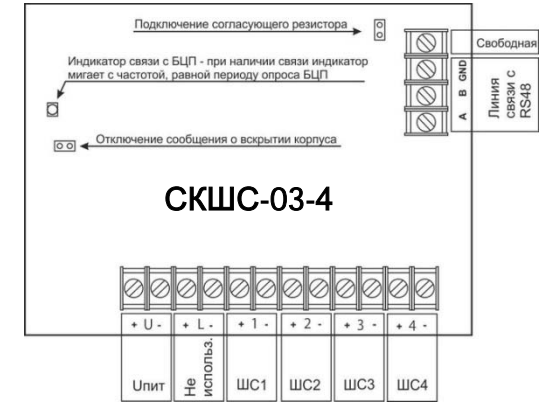
СКШС-03-4, 03-8 – гальваническая развязка ШС
