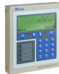
БЦП (исполнение 6) – в корпусе пульта ПУ-02 в едином конструктиве со встроенным пультом управления и электропитанием от внешнего источника
