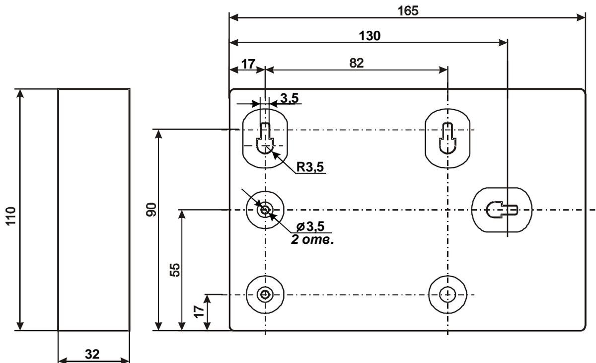
Рис. 2 Габаритные и присоединительные размеры корпуса ТИ
