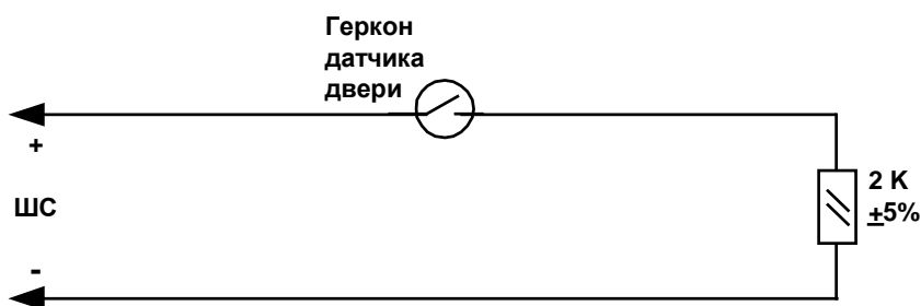
Рис. 18 ШС для контроля состояния датчика двери
