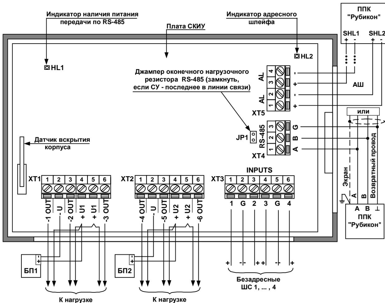
Рис. 1 SKIU-06. Расположение элементов. Подключение.
