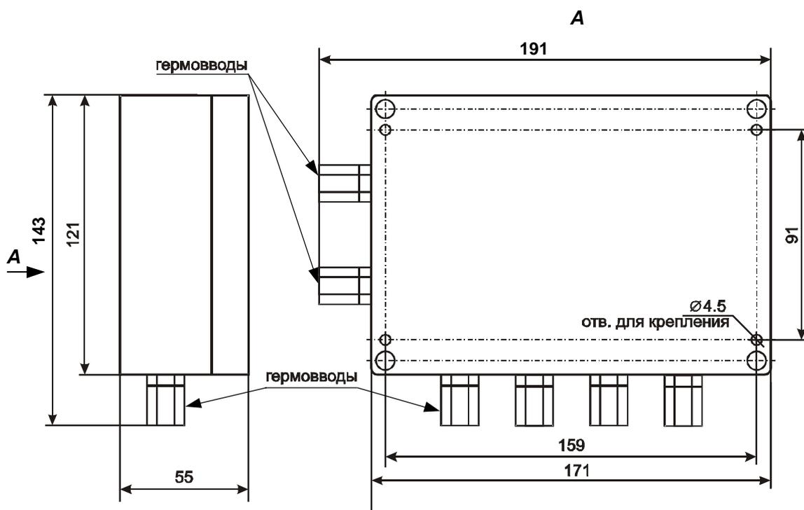
Рис. 3 Внешний вид, габаритные и присоединительные размеры (исполнение IP65)
