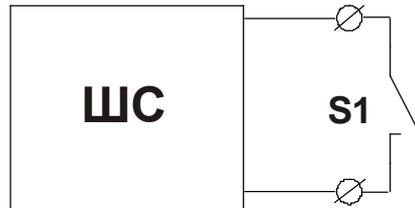
**Рис. Схема 4. Подключение извещателя (датчика) с НР контактами без контроля целостности линии связи.**
