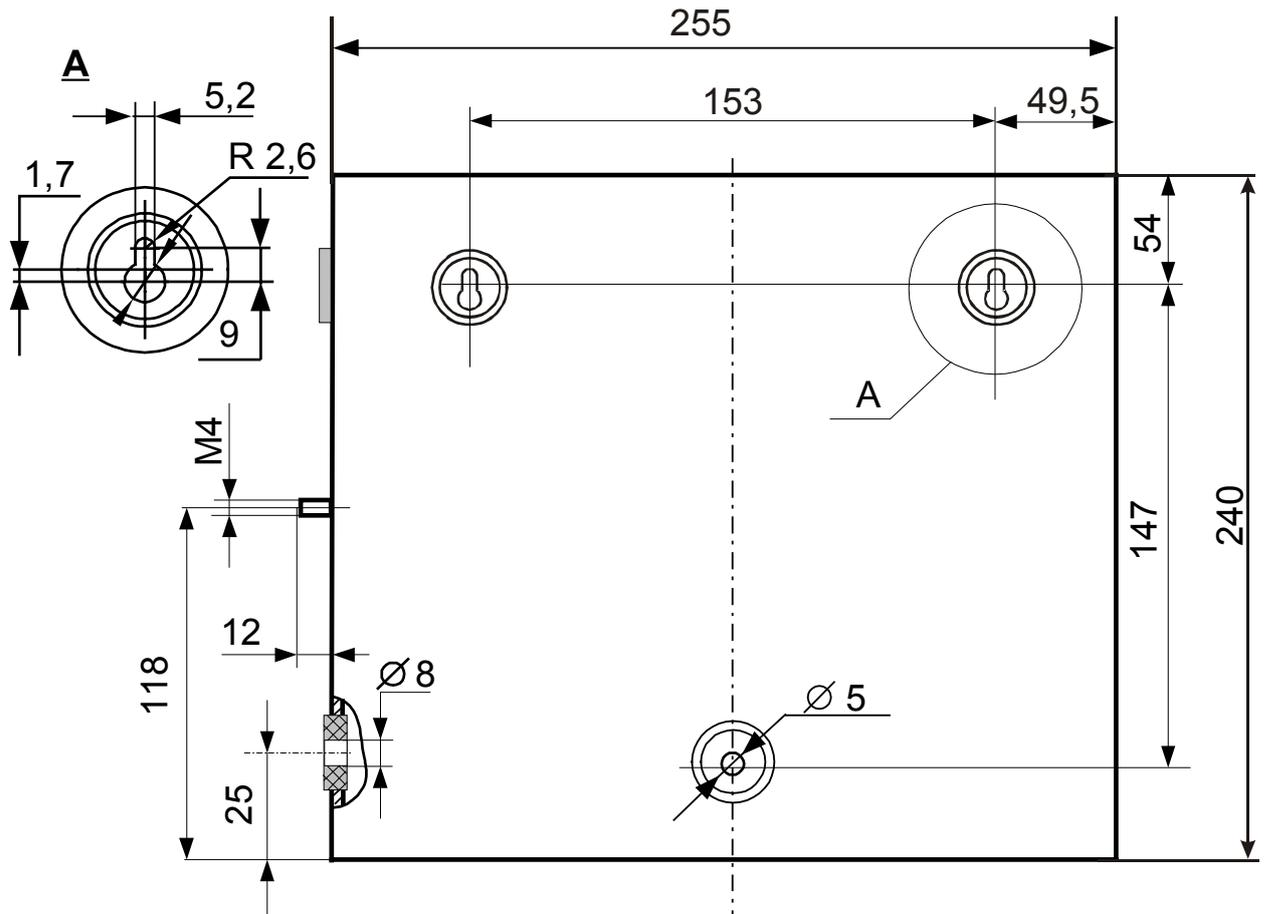
Рис. 11 Габаритные и присоединительные размеры СК-01 исп.3-1
